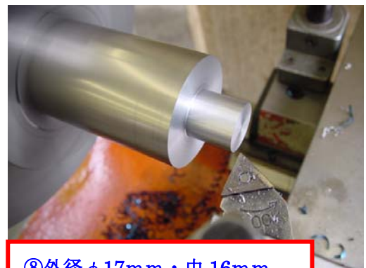
⑧外径 \phi 17\text{mm} ・巾 16mm
