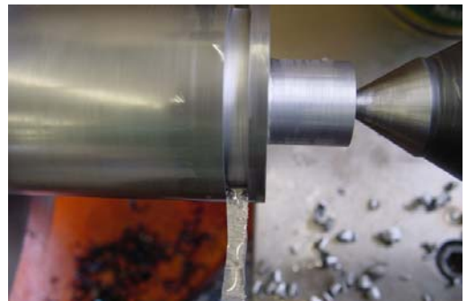
⑫83rpm 回転で、深さ 2mm (切削油塗布)
