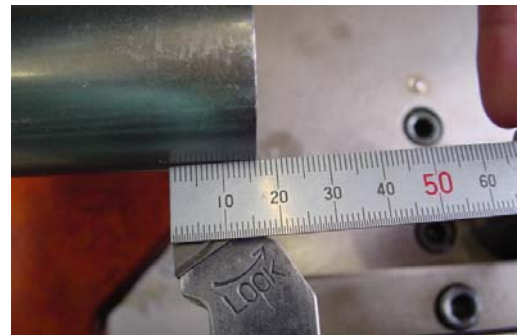
④バイト先端～加工物端面を 16mm にする
