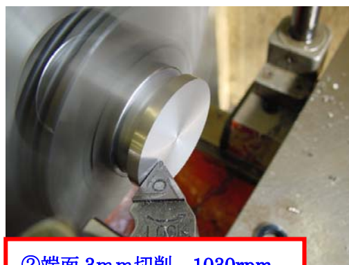
②端面 3mm切削 1030rpm
