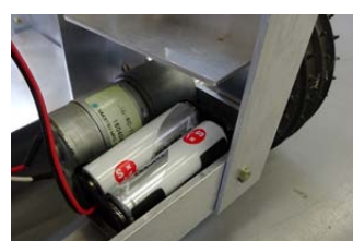
(写真-f) 受信機用電源ボックス
