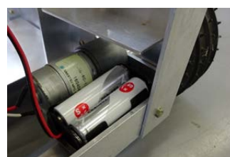
(写真-f) 受信機用電源ボックス
